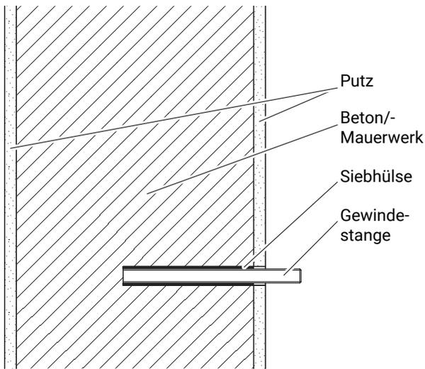
Das Befestigungssystem für das Vordach muss auf den Baustoff der Wand abgestimmt sein. Je nachdem, ob Sie das Vordach an Beton, Mauerwerk oder einer wärmegeprägten Fassade befestigen möchten, benötigen Sie das entsprechende Befestigungsmaterial. Für eine stabile Befestigung des Vordachs muss die Verankerung in einem tragfähigen Untergrund erfolgen.
