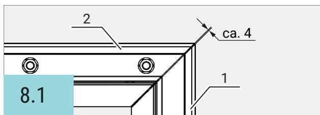
Das seitliche Grundprofil (1) mit ca. 4 mm Abstand zum oberen Grundprofil (2) montieren (Abb.: 8.1).
