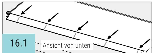
Auf die Rundung des Klemmprofils Silikon in Streifen auftragen (ca. drei Streifen pro Meter). Auf die Unterseite des Grundprofils auf die gleiche Weise Silikon auftragen (Abb.: 16.1).
