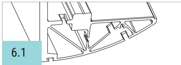
Damit das Kabel von den LED-Modulen später aus dem Abdeckprofil zum Trafo verlegt werden kann, müssen seitlich Aussparungen in das untere Profil gefräst werden.
