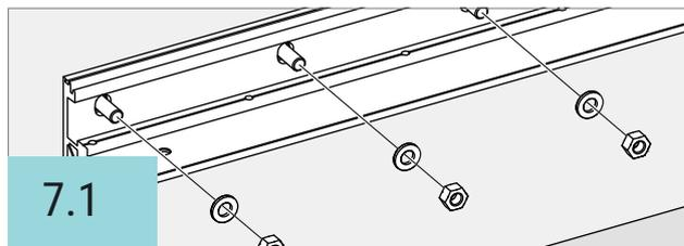
Nachdem der Injektionsmörtel ausgehärtet ist (Angaben des Herstellers beachten) das obere Grundprofil auf die Gewindestangen setzen (Abb.: 7).
