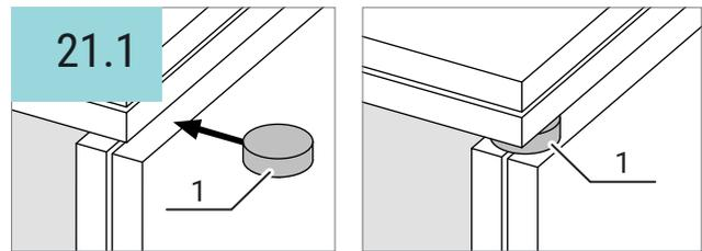
Damit sich die Glasscheiben unter größerer Last (z. B. Schnee) nicht berühren, den Gummipuffer (1) an der vorderen Kante zwischen die Glasscheiben kleben.
