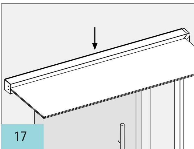
Den Spalt zwischen Wand und oberer Profilabdeckung mit Silikon verschließen, damit kein Wasser hinter das Profil laufen kann.
