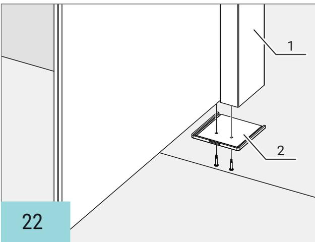
Die seitlichen Abdeckprofile (1), wie in den Schritten 16 - 17 beschrieben, montieren.
