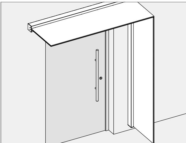
Diese Montageanleitung zeigt beispielhaft die Montage des Vordachs DURAVENTO mit einem Seitenteil. Die gezeigten Befestigungsmittel beziehen sich auf einen Untergrund aus Beton. Informationen zur Montage auf anderen Untergründen finden Sie auf den Seiten 08 - 09. Fragen Sie im Zweifelsfall einen Statiker oder Fachbetrieb. Führen Sie die Montage mit mindestens 2 Personen durch.
