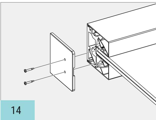
Die Endkappe auf die Profile setzen und mit zwei Bohrschrauben befestigen.
