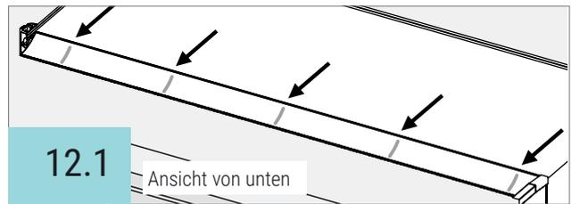
Auf die Rundung des Klemmprofils Silikon in Streifen auftragen (ca. drei Streifen pro Meter). Auf die Unterseite des Grundprofils auf die gleiche Weise Silikon auftragen (Abb.: 12.1).
