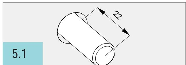
Die Bohrlöcher zu 2/3 mit Injektionsmörtel füllen. Die Gewindestangen M12 x 150 mm unter leichten Drehbewegungen bis zum Bohrlochgrund eindringen (Abb.: 5) und den überschüssigen Injektionsmörtel mit einem Tuch abwischen. Die Gewindestangen kragen ca. 22 mm aus der Wand aus (Abb.: 5.1).
