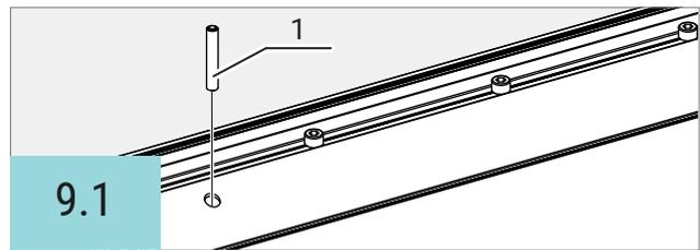
Die beiden Sicherungsstifte (1) einsetzen.
