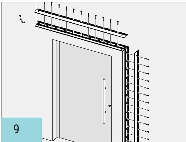
Auf beide Grundprofile das jeweils passende Klemmprofil setzen und mit Zylinderschrauben M8 x 60 mm locker anschrauben.
