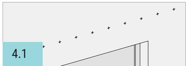
Das obere Grundprofil mit einer Wasserwaage waagrecht ausrichten und alle Bohrungen für die Wandbefestigung mit einem Stift auf die Wand übertragen.
