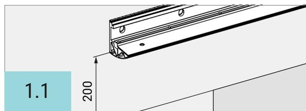
Das obere Grundprofil (1) mittig über der Türöffnung auf die Wand setzen. Der Abstand zur oberen Türkante sollte ca. 200 mm betragen (Abb.: 1.1). Bei Bedarf das seitliche Grundprofil (2) zum Positionieren zu Hilfe nehmen.
