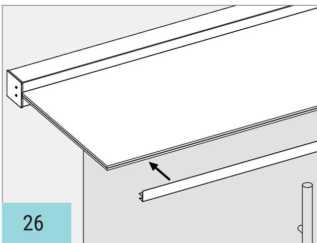
Die Regenrinne mittig ausgerichtet an die Glas-kante setzen und bis zum Anschlag auf das Glas schieben.
