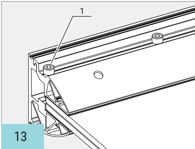
Die Schrauben des Klemmprofils (1) der Reihe nach mit 20 Nm festziehen.
