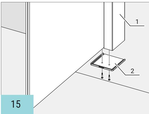
Die seitlichen Abdeckprofile (1) und die untere Endkappe (2), wie in den Schritten 12 - 14 beschrieben, montieren.
