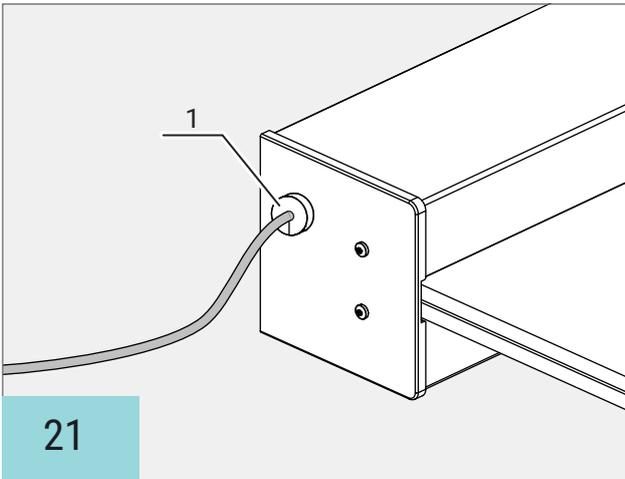
Eine Kabeltülle (1) an einer Seite aufschneiden, auf das Kabel setzen und in die Bohrung der Endkappe drücken.
