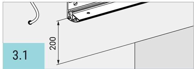
Das obere Grundprofil (1) mittig über der Türöffnung auf die Wand setzen. Der Abstand zur oberen Türkante sollte ca. 200 mm betragen (Abb.: 3.1). Bei Bedarf das seitliche Grundprofil (2) zum Positionieren zu Hilfe nehmen.
