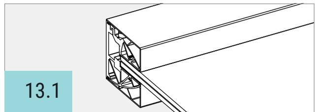
Die Abdeckprofile (1) jeweils von oben und von unten auf das obere Grundprofil (2) und das obere Klemmpprofil (3) setzen. Dabei darauf achten, dass die Abdeckprofile auf der rechten Seite unter die Gehrungsblende geschoben werden und auf der linken Seite bündig mit dem Grund- und dem Klemmpprofil abschließen (Abb.: 13.1).
