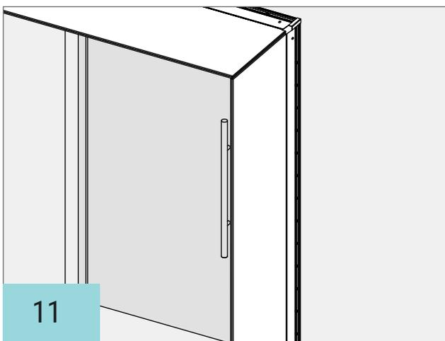
Die seitliche Glasscheibe zwischen die beiden seitlichen Profile schieben und an der unteren Kante bündig zu den Profilen ausrichten. Wie in den Schritten 9 und 10 beschrieben, die Sicherungsstifte einsetzen und die Schrauben des seitlichen Klemmprofils der Reihe nach mit 20 Nm festziehen.
