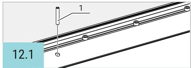
Die beiden Sicherungstifte (1) einsetzen.
