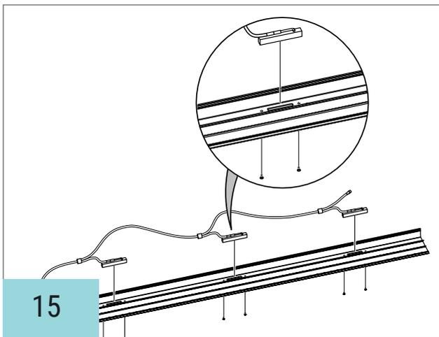
Die LED-Module in die Aussparungen des unteren Abdeckprofils setzen und mit jeweils zwei Senkkopfschrauben M3 x 8 mm befestigen.
