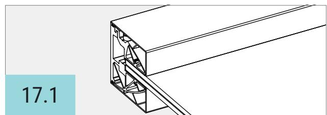
Die Abdeckprofile (1) jeweils von oben und von unten auf das obere Grundprofil (2) und das obere Klemmprofil (3) setzen.
