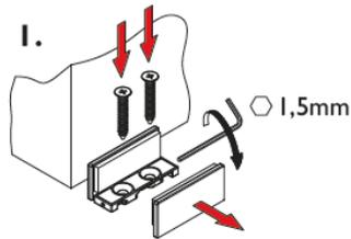
Lösen Sie den Adapter der Bodenführung und befestigen Sie den Grundkörper am Boden. Zeichnen Sie die Bohrlöcher ein und bohren Sie die Löcher in den Boden. Schrauben Sie die Bodenführung nun fest. Der Adapter wird nach Einsetzen der Scheibe wieder angeschraubt.
