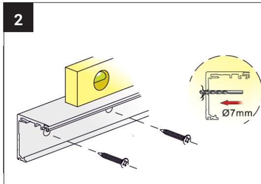
Die Laufschiene hat vorgesenkte Schraublöcher für Decken- oder Wandbefestigung. Benötigte Befestigungspunkte sollten nun durchgebohrt werden. Bei Bedarf diese nachsenken. Das Profil ist für Senkkopfschraube bis 5mm nach DIN vorbereitet. Ermitteln Sie zunächst die korrekte Höhe der Lochbohrungen in Wand oder Decke und richten Sie diese mittels einer Wasserwaage aus. Vergewissern Sie sich, dass die Laufschiene fest an Decke oder Wand angeschraubt ist.
