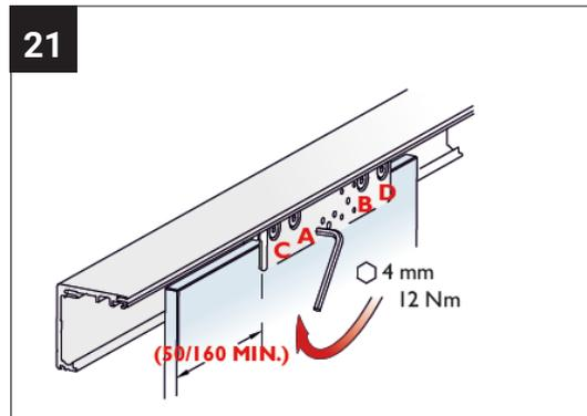
Positionieren Sie die Laufwagen nun rechts und links der Glastür.
