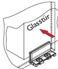
Achten Sie auf eine lotgerechte Montage. Bei Unebenheiten oder bei Verwendung eines Hinterfüterungsprofils muss die Position der Bodenführung angepasst werden.
