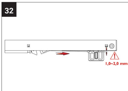
Für den Luftdruck-Lämpfer beträgt der Abstand ca. 1 bis 2 mm. Dazu muss der Fanghaken, wie in der Zeichnung gezeigt, eingerastet werden. Somit ist die optimale Funktion des Selbstenzuges gegeben.
