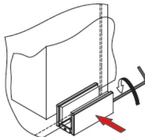
Der Adapter wird nach Einsetzen der Scheibe wieder angeschraubt.
