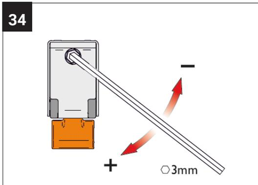
Beim Einsatz des Öldruckdämpfers ist eine Einstellung der Einzugskraft möglich. Diese kann auch vor der Montage in die Laufschiene vorgenommen werden.
