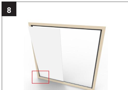
Setzen Sie das Glas leicht geneigt ins Bodenprofil und drücken es an, damit es gerade steht. Schieben Sie es in das U-Profil der Wand.
