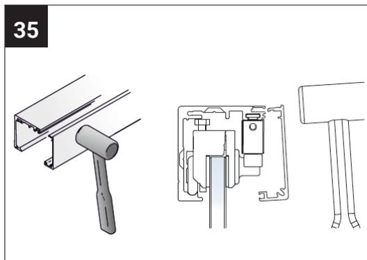
Nachdem der Endanschlag der Schiebetüre eingestellt ist, kann die Abdeckkappe aufgeklipt werden.
