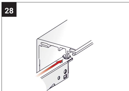
Schieben Sie den Selbststeinzug mit den Muttern in die Nut des Profils.
