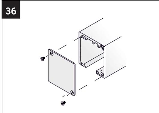
Sofern die Schiene nicht zwischen zwei Wänden sitzt, montieren Sie nun die Endkappen links und/oder rechts mit den beigefügten M3 Kreuzschlitzschrauben. Mit der Montage der Endkappe wird zudem das Frontprofil zusätzlich fixiert.
