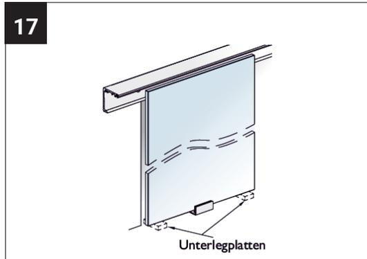
Stellen Sie nun die Glastüre in die Bodenführung. Hilfreich ist es, wenn Sie zwei Unterlegplatten (13 mm Höhe) unter die Glastüre legen. Somit ist eine optimale Ausrichtung der Glastür möglich.
