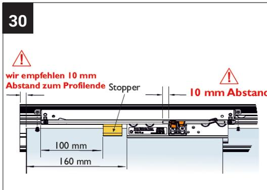
Der Selbstenzug kann mittels dem M4 x 5 mm Schrauben in der Lauf-schiene befestigt werden. Der Selbstenzug lässt sich stufenlos in der Lauf-schiene verschieben. Somit ist auch der Endanschlag stufenlos einstellbar.
