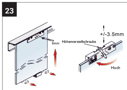
Mit der Höheneinstellschraube kann nun beidseitig die Glastür leicht angehoben werden um die Unterlegkeile zu entfernen. Zudem kann nun die Glastür, wenn nötig, ausgerichtet werden.
