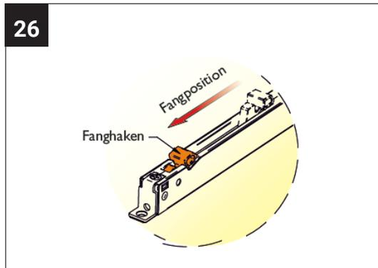
Der Fanghaken des Selbstzieges sollte vor der Montage in die Fangposition gebracht werden.
