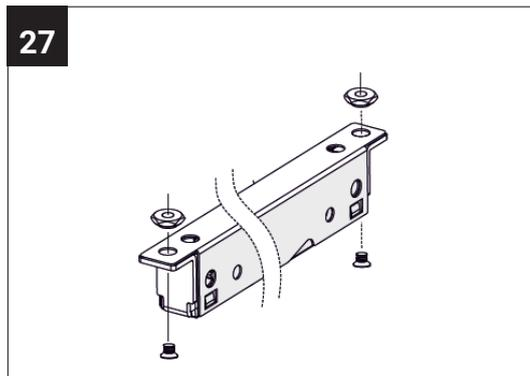
Montieren Sie die Gewindenocken (Mutter) an den Selbststeinzug.
