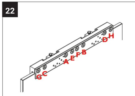
In dieser Position klemmen Sie nun die Glastür im Laufwagen fest. Die Schrauben müssen mit dem SW 4 Innensechskantschlüssel mit 12 Nm verschraubt werden. Die Montage erfolgt in der Reihenfolge laut Zeichnung.
