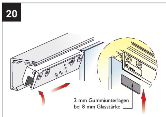
Bei 8 mm Glasstärke setzen Sie zuerst die 2 mm Gummiunterlagen (Gasket) in den Laufwagen.
