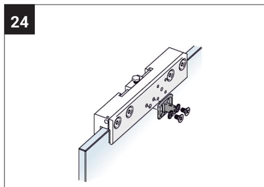
Bevor der Selbsteinzug in die Laufschiene eingeschoben wird, muss zunächst der Mitnehmer auf dem Laufwagen montiert werden.
