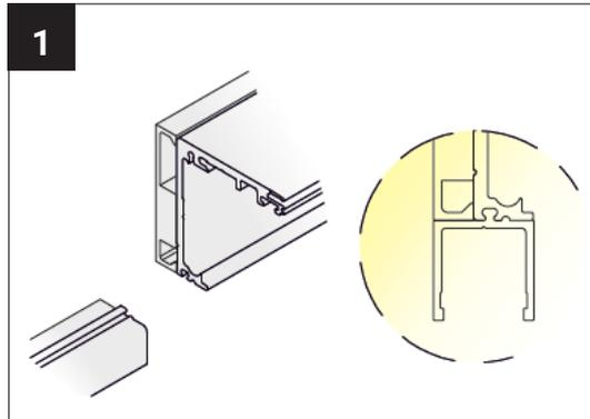
Schieben Sie das Zusatzprofil für das Festteil in das Laufprofil ein. Die Laufschiene weist dafür eine Nut an der Unterseite auf.
