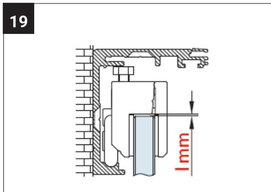
Achten Sie darauf, dass der Abstand zwischen Laufwagen und Glastür nicht mehr als 1 mm beträgt. Den Abstand können Sie mittels der Höhenverstellungsschraube anpassen.
