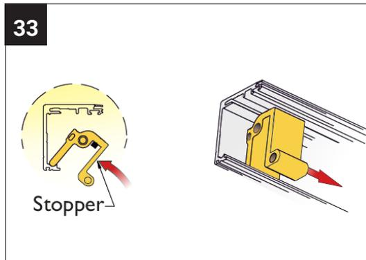
Zur Sicherung der Tür gegen das Herausfallen durch unsachgemäße Betätigung der Schiebetüre montieren Sie die beiliegenden Endstopper an beiden Seiten der Laufschiene. **Bei Türen mit Softclose demontieren Sie dazu die beiden Federzungen des Stoppers, indem Sie die beiden Madenschrauben im Stopper lösen.**
