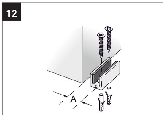
Bevor Sie die Bodenführung montieren, prüfen Sie die Glasstärke der Scheibe. Die Bodenführung ist für Glasstärken von 8 bis 10,76 mm einstellbar.
