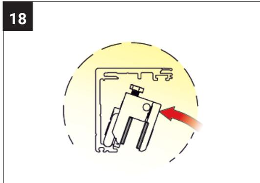
Nun können die Laufwagen von beiden Seiten in die Laufschiene eingeschoben werden: Eine Montage von vorne ist ebenfalls möglich. Dazu muss der Laufwagen in ca. 20 Grad Schräge von vorne in das Laufprofil aufgesetzt, senkrecht gestellt und über das Glas geschoben werden.
