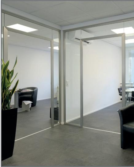
Mit der Glastrennwand Slim lassen sich große Räume teilen, ohne die Lichtverhältnisse und die optische Weite einzuschränken. Mit dem schmalen Klemmprofil von nur 41 mm Höhe besitzt die Glastrennwand einen besonders hohen Glasanteil, wodurch Transparenz und Lichteinfall in optimaler Weise gegeben sind.
