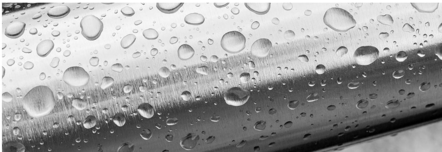
Der Einsatz salzsäurehaltiger Reinigungsmittel an und in der Nähe von Bauteilen aus Edelstahl ist in jedem Falle zu unterlassen. Auch die Chlor-Werte im Schwimmbadwasser spielen für die Korrosion von Edelstahl eine große Rolle. Selbst eine kurzfristige Überschreitung der Grenzwerte kann zu Korrosion führen, wenn die Edelstahlstelle danach nicht ausreichend und fachgerecht gereinigt wird, sodass sich die Passivschicht erneuern kann.
