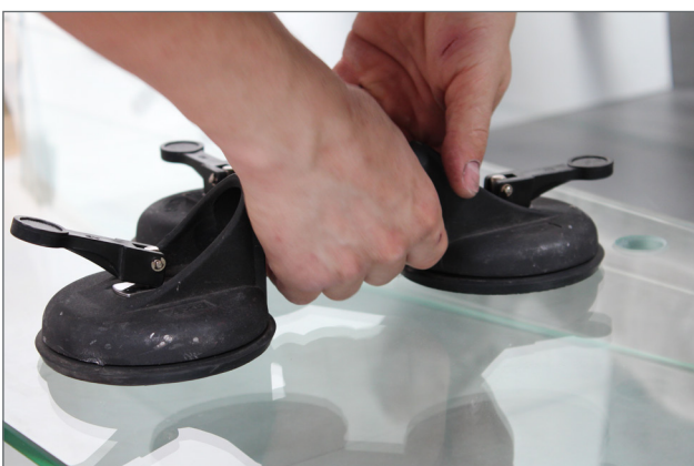
Einsatz eines Glassaugers
