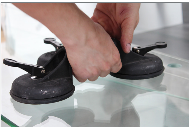
Einsatz eines Glassaugers
