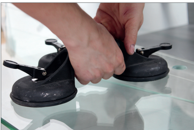
Einsatz eines Glassaugers
