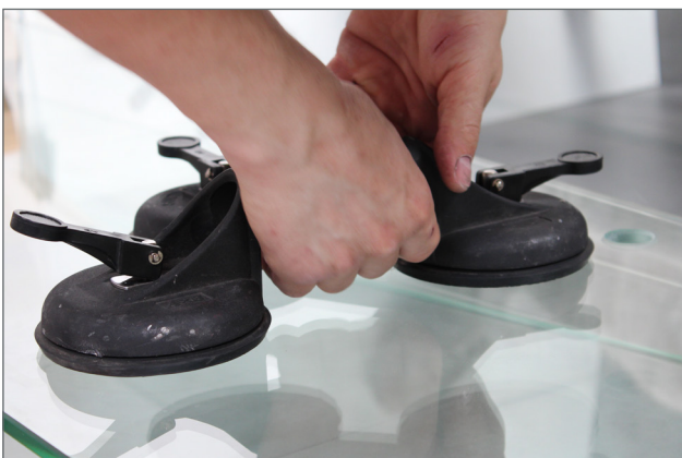
Einsatz eines Glassaugers
