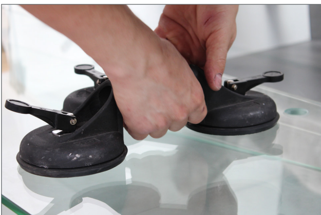
Einsatz eines Glassaugers
