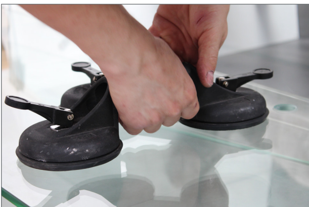
Einsatz eines Glassaugers
