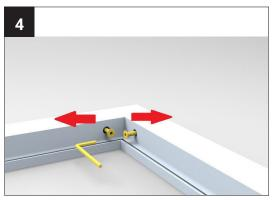
Schrauben Sie nun das andere Seitenteil an die Kopfzarge. Arbeiten Sie auch hier abwechselnd schraubend.
