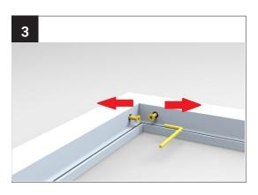
Schrauben Sie zuerst ein Seitenteil und die Kopfzarge locker zusammen. Wechseln Sie beim Festschrauben zwischen Seitenteil und Kopfzarge hin und her, damit sich die Zargenteile formschüssig verbinden.
