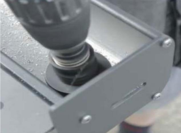
Montage für Ablaufstutzen mit Kreislochsäge 48 mm an der gewünschten Stelle bohren.
