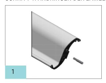
1. Die Inox-Achse am Flansch anbringen.
