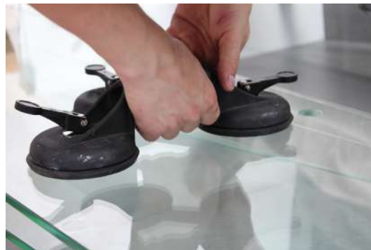
Einsatz eines Glassaugers
