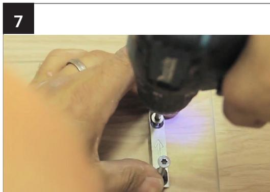
Schrauben Sie die Schwalbenschwanzplatte an der Wand fest.
