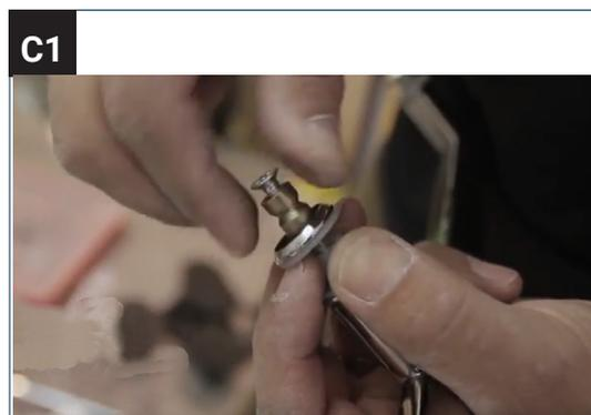
Lösen Sie die obere Schraube der Griffstange und demontieren die Verschraubung.
