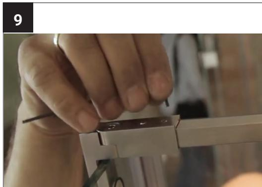
Montieren Sie nun wieder alle Beschläge an der Stange und ziehen Sie alle Schrauben gut an.
