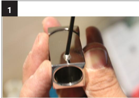
Lösen Sie die Madenschraube an der Oberseite der Wandmuffe.
