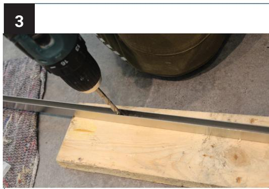
Legen Sie das Profil auf ein Holzbrett. Bohren Sie die Löcher mit einem Metallbohrer.
