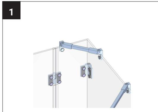
Die 90° Verbindung über Eck ist je nach Einbausituation entweder mit 2 Festteilen (s. Abb.) oder 1 Festteil und Tür ausgeführt.
