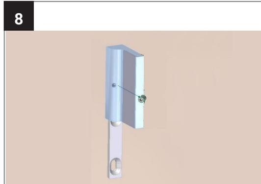
Schieben Sie den Winkel auf die Schwalbenschwanzplatte und fixieren ihn mit der Madenschraube.
