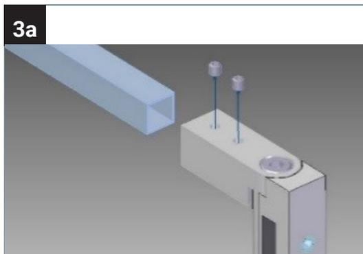
Befestigen Sie nun die Glasklemme an der Stange. Lösen Sie hierfür die Madenschrauben an der Oberseite.
