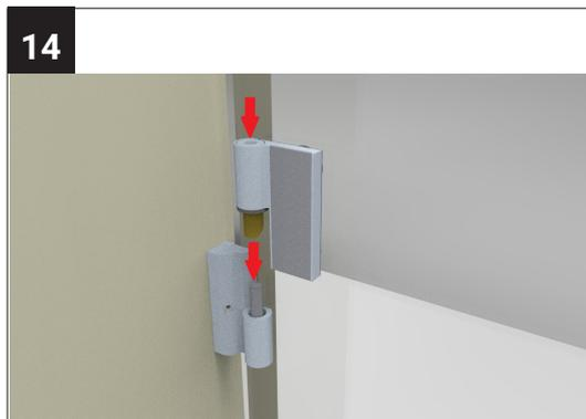
Heben Sie die Glastür mit Hilfe eines Glasgaugers an und setzen sie am oberen und unteren Türbandteil parallel ein.
