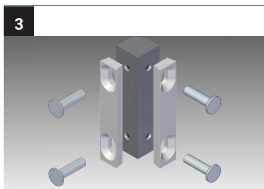
Befestigen Sie die Schwalbenschwanzplatten am Eckverbinder.
