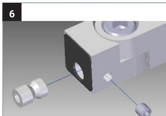
Lösen Sie die Madenschraube und entnehmen Sie die Schraubenaufnahme.
