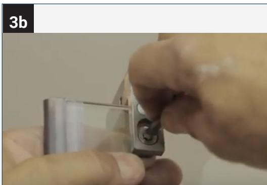
Sofern Sie statt einer Glasklemme einen Glashalter verwenden, verschrauben Sie diesen mit einem Inbusschlüssel im Glas.
