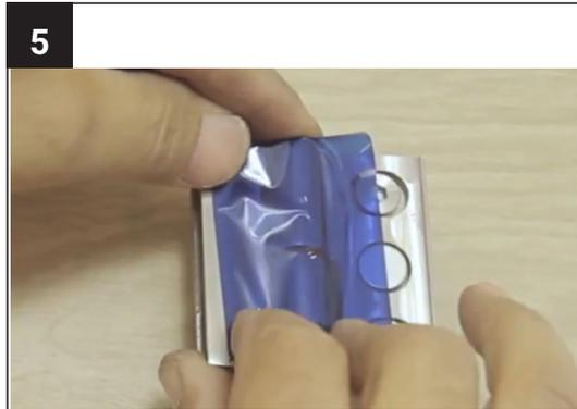
Fixieren Sie das Türband mit einem Klebeband.
