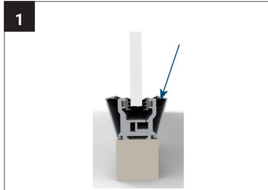
Klipsen Sie die Blende ab, die über der Verschraubung sitzt. Die andere Blende muss nicht entfernt werden.
