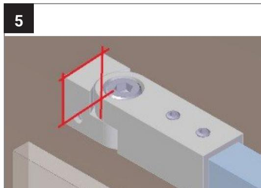
Markieren Sie mit einem Stift umlaufend die Muffe an der Wand.
