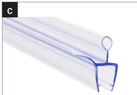
Die Bodendichtung ist zum Abdichten der Türunterkante geeignet. Dabei wird die Lippe zur Dusch-Innenseite hin montiert, damit das Wasser zurück in die Dusche geleitet wird.
