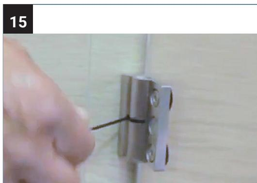
Fixieren Sie das Band an der Schwalbenschwanzplatte, indem Sie die Madenschraube mit einem Inbusschlüssel festschrauben.
