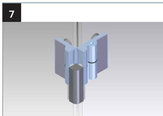
Schieben Sie den Eckverbinder mit den Schwalbenschwanzplatten von unten in die Beschläge ein und fixieren Sie diesen mit der Madenschraube.
