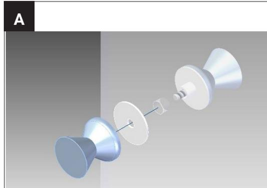
Schrauben Sie den beidseitigen Türgriff auseinander und setzen Ihnen gemäß der Reihenfolge in der Abbildung im Glas zusammen. Schrauben Sie beiden Seiten parallel an.
