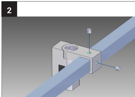
Sofern Sie eine Parallelklemme verwenden, schieben Sie diese nun aufs Rohr.
