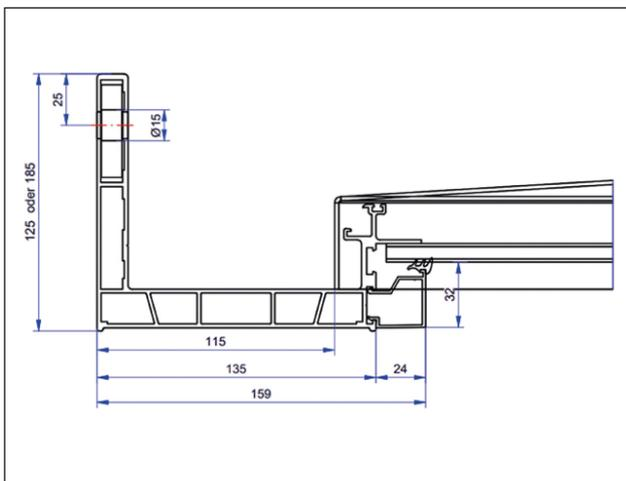
Das 4-seitige Rahmen-Rinnenprofil ist an der Wandseite bereits mit 15 mm vorgebohrt. Die Verschraubung/ Befestigung hat durch jede Bohrung mit einem 12 mm Schwerlastdübel oder durch
