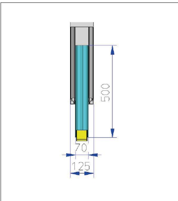
Auf druckfestem Mauerwerk ist die Montage des Vordachs bis zu einer maximalen Breite von 4,20 m auch ohne Eckstützen oder Seitenteile zulässig. Auf dem fertigen Fußboden ist ein Verkleben des Seitenteilrahmens ohne Verschraubung eine Alternative. Ist ein Fundament vorhanden, kann ein innen geführtes Rechteckrohr nach unten verschoben und durch einen Bodenwürfel verschraubt werden.
