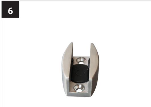
Bei einem Fliesenuntergrund sollte die Bodenführung nur geklebt und nicht gebohrt werden. Das Kleben sollte einen Tag vor Einsatz des Glases erfolgen, damit die Aushärtezeit eingehalten wird.
