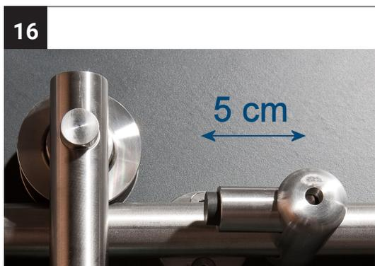
Um den Stopper an der richtigen Position zu fixieren, schieben Sie den Laufwagen direkt an den Gummistopper und markieren die Außenkante der Laufwagenstange. Der Stopper wird 5 cm weiter rechts bzw. links fixiert.
