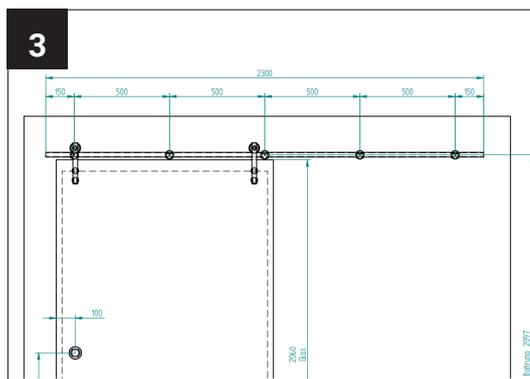
Zeichnen Sie die Bohrlöcher an. Die Bohrlochabstände der Halter entnehmen Sie bitte Ihrer technischen Zeichnung. Sofern bauseits erforderlich, können Sie diese Abstände leicht verändern. Der Abstand der äußeren Wandhalter zum Laufschienen-Ende von 150 mm sollte eingehalten werden.
