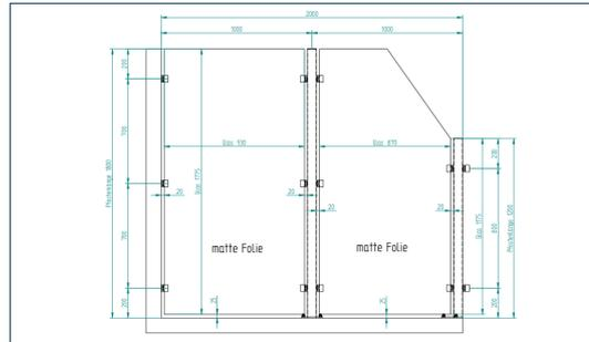
Erstellen Sie anhand der technischen Zeichnung Ihres Produktes einen Bauplan, in dem Sie die Pfostenabstände und Position der Einzelemente festlegen. Bei einer wandseitigen Befestigung empfehlen wir Ihnen, die Planung von der Wand ausgehend vorzunehmen. Die Ausrichtung der einzelnen Glaszaun-Felder sollte an der Oberkante vorgenommen werden.
