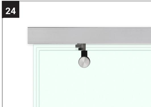
Setzen Sie den Glashalter probeweise in den Glasausschnitt der Schiebetür ein. Passt die Position, schrauben Sie die Glashalter fest.
