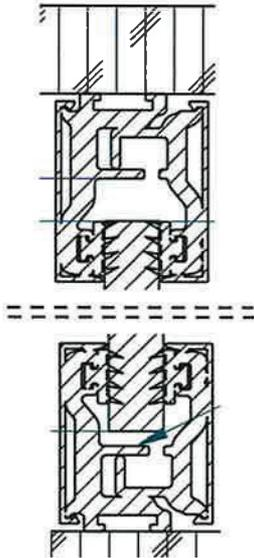
Die Bauart – absturzsichernde Verglasung / raumhohe Verglasung als innere Trennwand – besteht im Wesentlichen aus zweiseitig – oben und unten – liniengelagerten Verglasungen, die in Klemmschienen aus Aluminium (EN AW-6060 T5) eingebaut werden. Die Scheibeneinstände oben und unten betragen mindestens 18 mm.
